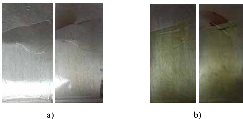
Рис. 3. Зразки з покриттями на основі БДФО (а), композиції БДФО та 5% вмісті епоксидної смоли (б) до та після витримки у 5% розчині NaCl
