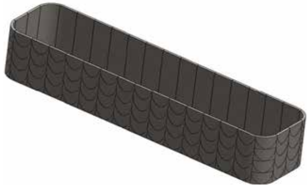
Рис. 2. Перспективна концепція кузова вантажного напіввагону з поліуретанового матеріалу
