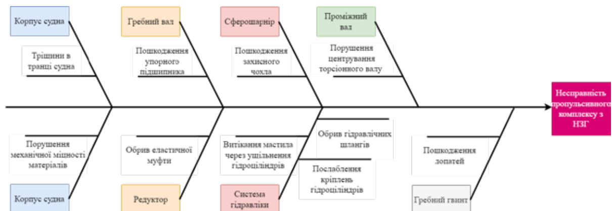
Рис. 5. Діаграма Ішикави несправностей основних функціональних вузлів ПК з НЗГ
