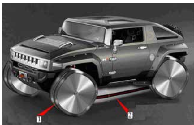
Рис. 3. Автомобіль-амфібія з рушієм Shark Wheel 1 – пустотіла оболонка двокільцевого колеса; 2 – надувні елемнти Shark
