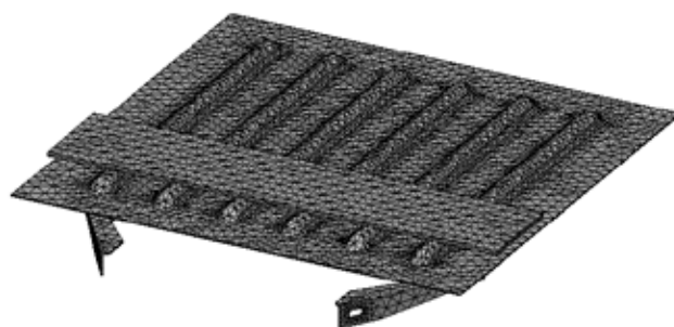
Рис. 7. Скінчено-елементна модель кришки люка
